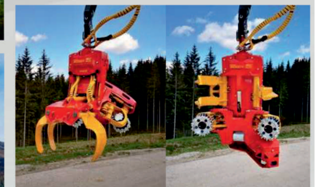
Откидывающийся вверх узел подачи обеспечивает возможность полной загрузки грейфера, с бесконечным вращением
