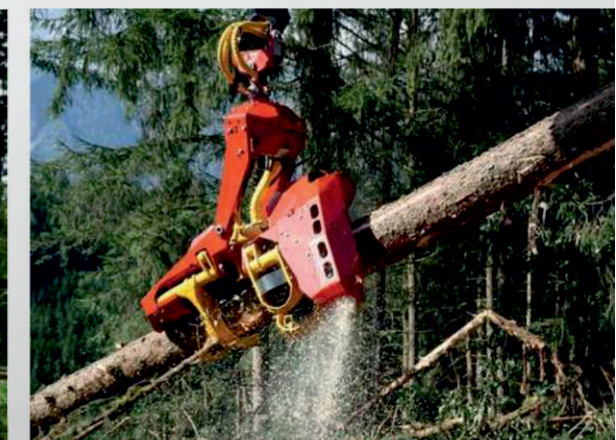
Длина агрегата WOODY обеспечивает контролируемую валку крупных деревьев
