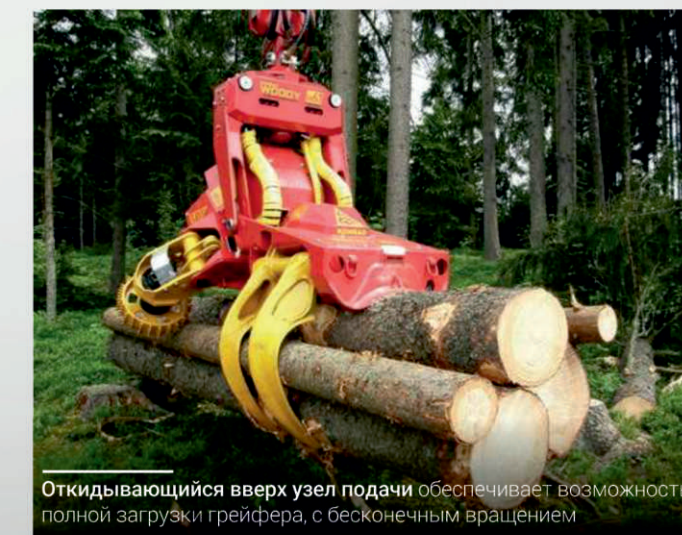
Длина агрегата WOODY обеспечивает контролируемую валку крупных деревьев
